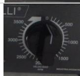
VARIADOR ELECTRÓNICO DE VELOCIDAD DE 500 A 2500 R.P.M.
