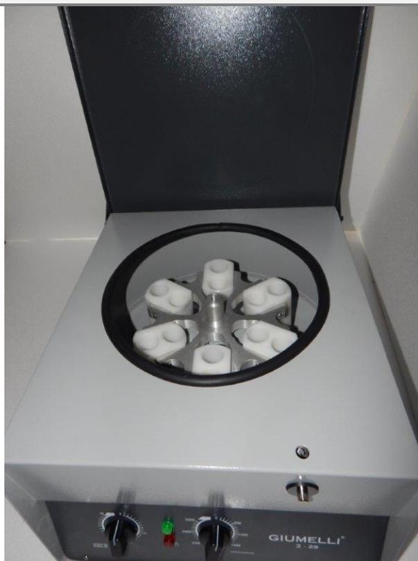
GABINETE Y BACHA INTERNA CONSTRUIDOS TOTALMENTE EN ACERO, TRATAMIENTO EPOXI EN SU PINTURA. TAPA CON CIERRE A PRESIÓN CON CORTE DE ENERGÍA A LA APERTURA DE LA MISMA.
