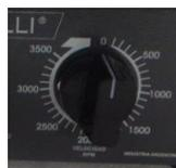
VARIADOR ELECTRÓNICO DE VELOCIDAD DE 500 A 3500 R.P.M.
